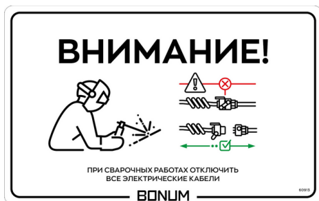
Предупредительная наклейка «При сварочных работах»
